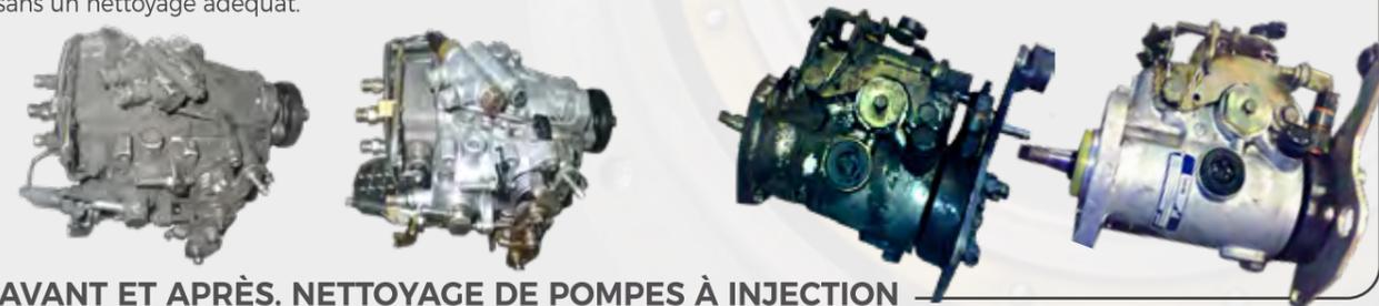
AVANT ET APRÈS. NETTOYAGE DE POMPES À INJECTION
